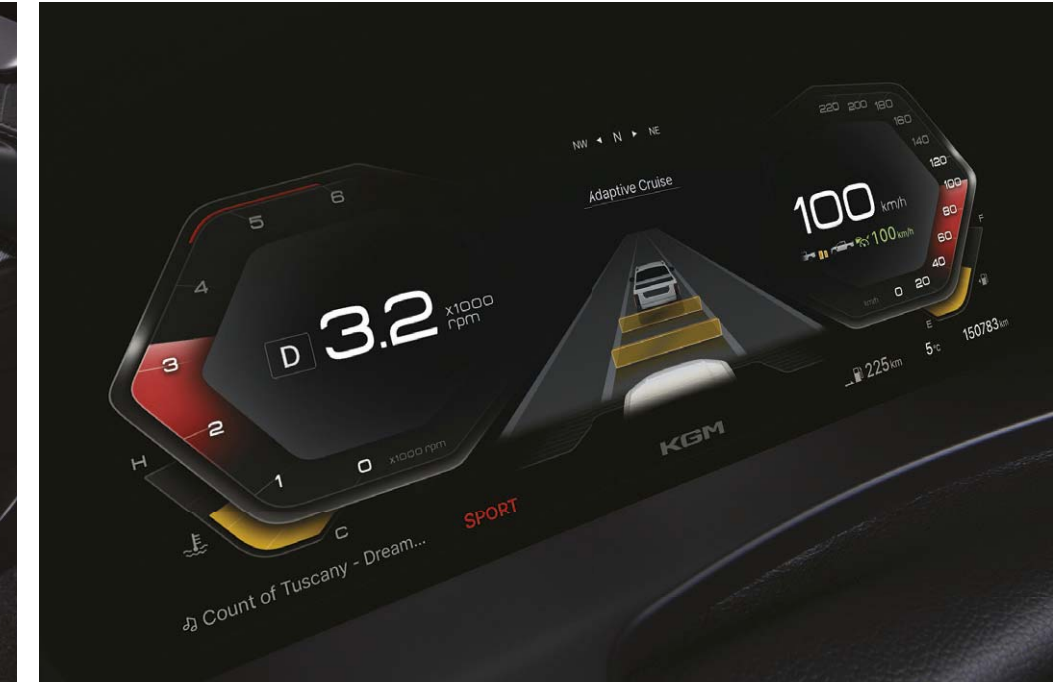
12,3 colos digitális műszeregység (Athena 3.0 GUI)
