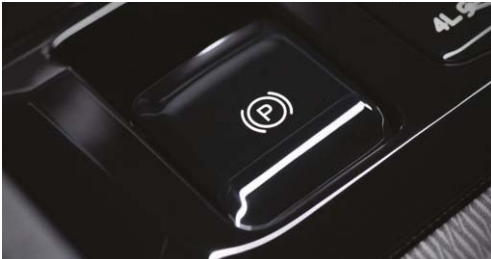
Elektronikus rögzítőfék (EPB) * Automatikus elgurulás-gátlással
